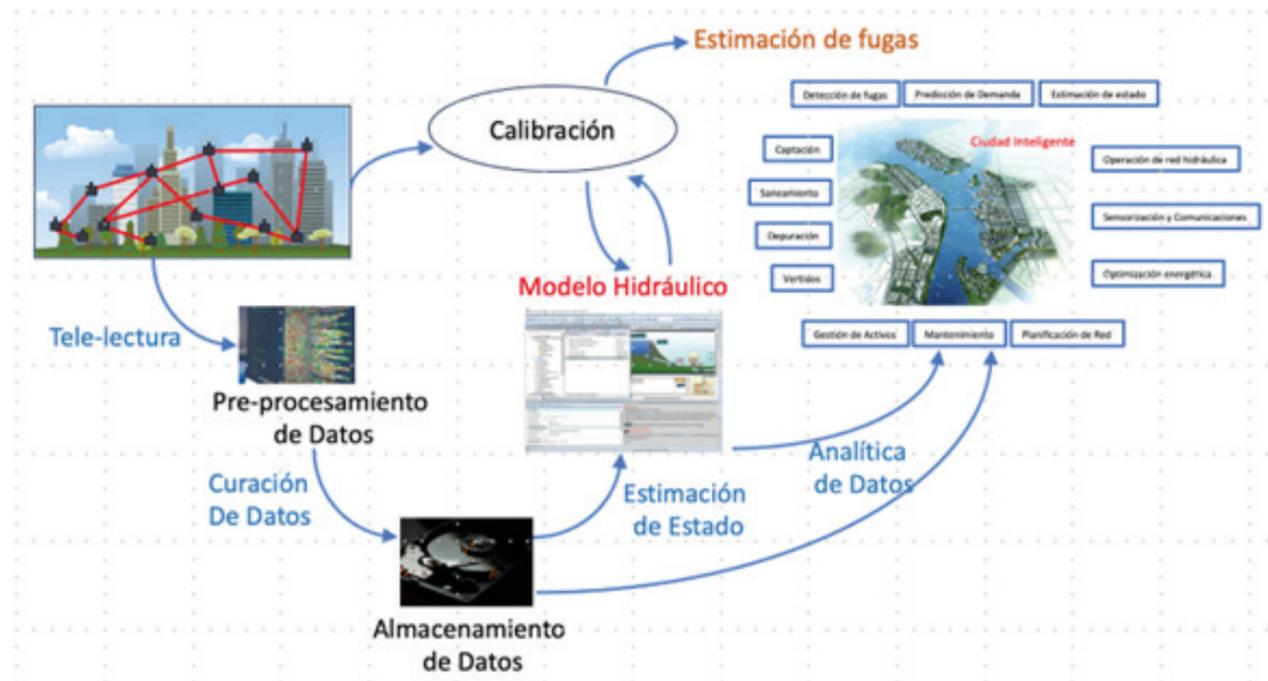
Figura 37. Componentes principales de un sistema de análisis de red incluyendo modelos hidráulicos basados en datos.
